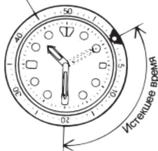
Кольцо не может поворачиваться в противоположном направлении, поскольку оно оснащено защитным механизмом, предназначенным для защиты от ошибочной операции в результате приложения силы или удара. Цифры на вращающемся кольце также могут упростить считывание текущего времени.
